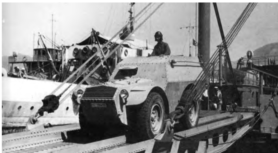
Fig. 16 - Gaeta, agosto 1942: dall' Aspromonte sbarca un trasporto truppa protetto tipo A.S. 37 della SPA. Costruito in pochi esemplari, poteva caricare dieci uomini in assetto di combattimento oltre al guidatore (da GABRIELE, Operazione C3 ).
